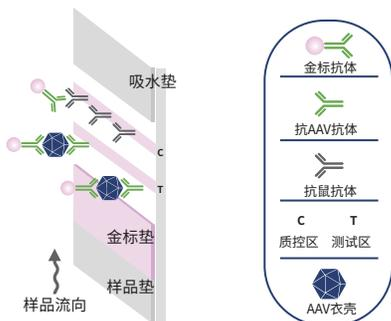
图. AAV病毒检测侧流免疫层析原理
